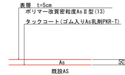
舗装段差すり付け詳細図 S=1/10
